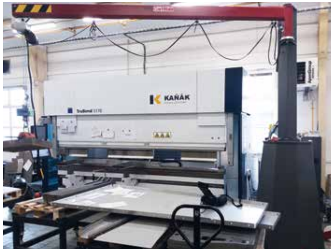
Mobilní sloupový jeřáb od Carl Stahl odboural v úseku manipulace s plechy ruční práci. Současně plní požadavek na přesun pracovního místa v budoucnu.
