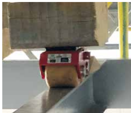
Transportní podvozky od Jung jsou díky svým rozměrům vhodné pro posun těžkých břemen po traverze.
